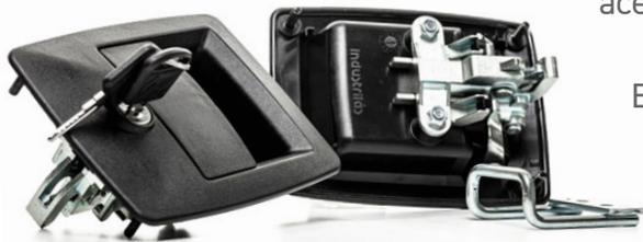
Estas cerraduras de paleta de acción de golpe están diseñadas con una manija con agarre único disponible como paleta UNIVERSAL, IZQUIERDA o DERECHA que se ensambla en su puerta con un soporte de montaje o con cuatro insertos roscados moldeados que brindan un ensamble de montaje completamente ciego.
